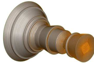
(c): Maillage surfacique de paroi reconstruit pour une configuration Ariane 5 lisse
