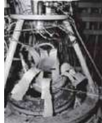
Chambre de combustion détruite par les instabilités thermo-acoustiques [1]
