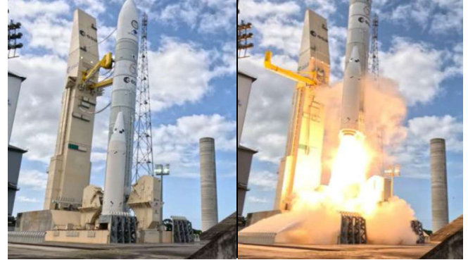
Décollage du vol inaugural d'Ariane 6 à T-2s (gauche) et T+2s (droite) Pas de tir au repos à gauche et interaction du déluge avec le lanceur à droite
