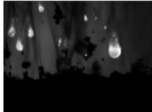
Image de la combustion de propulseur obtenue par ombroscopie
